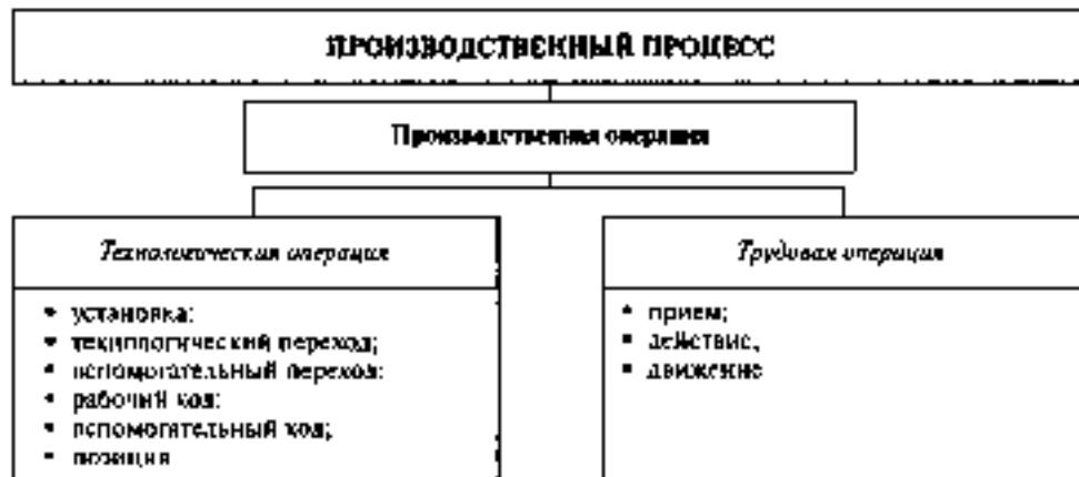
Рис. 3.1. Состав производственной операции в технологическом и трудовом отношении (на примере станочных работ)<sup>1</sup>
